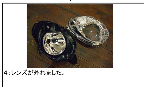
3: 温めながら、プラスチックのヘラ等で ゆっくりとレンズ面を外して行きます。
